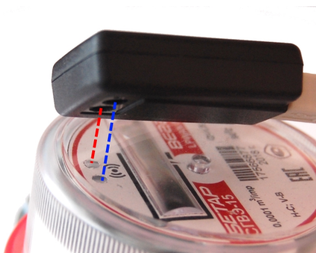
Р и с у н о к 7 — Расположение адаптера «Оптопорт-USB» относительно счетчика_Общий вид
