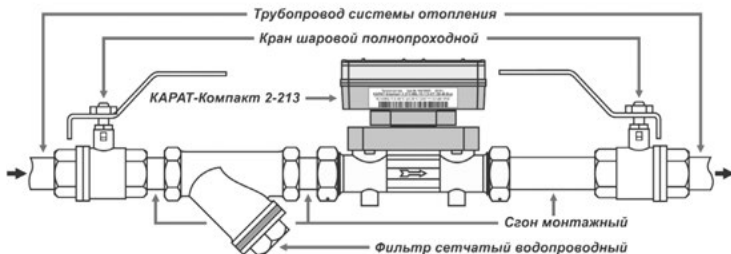
Рисунок 13 – Пример монтажа теплосчетчика в трубопровод
