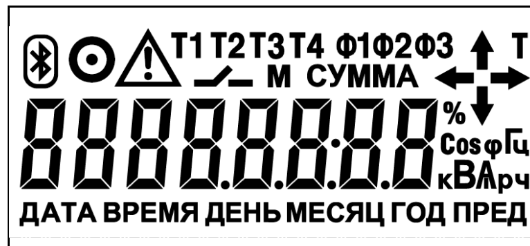
Рисунок 4.10 – Внешний вид ЖКИ счетчиков с индексом «ш» в коде
