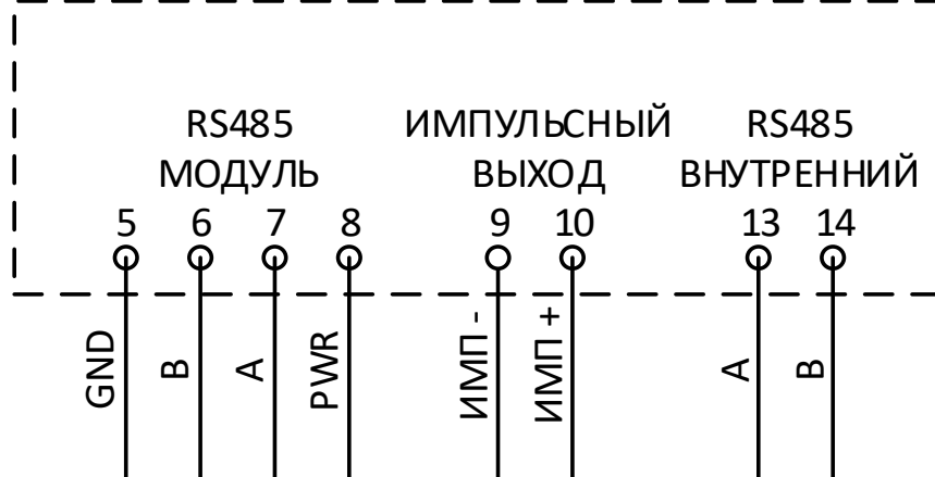
Рисунок Б.9 – Схема подключения интерфейсов и вспомогательных цепей «Меркурий 204»
